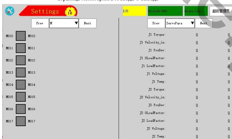
Страница мониторинга промежуточной переменной/параметра сервопривода
